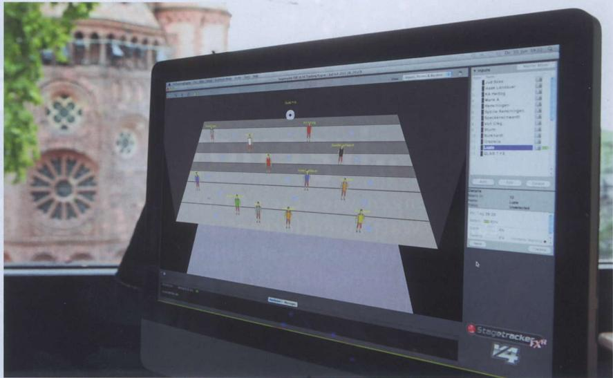
Innerhalb der StageTracker-Software werden die TurboTags, die sich im Empfangsbereich der Antenne befinden, als animierte Figuren dargestellt
