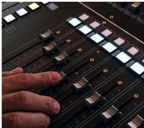
**Übersicht** Wird ein Fader am Pult berührt, leuchtet darüber eine rote LED – dazu werden zugehörige Kanäle auf dem Bildschirm signalisiert
